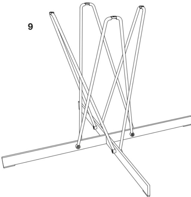
Posizionare la struttura pre assemblata sulla piastra montata sotto il piano tavolo facendo corrispondere i fori di assemblaggio presenti sulla piastra con quelli presenti sulla struttura fig 10 inserire le 4 viti in dotazione e serrarle a fondo
