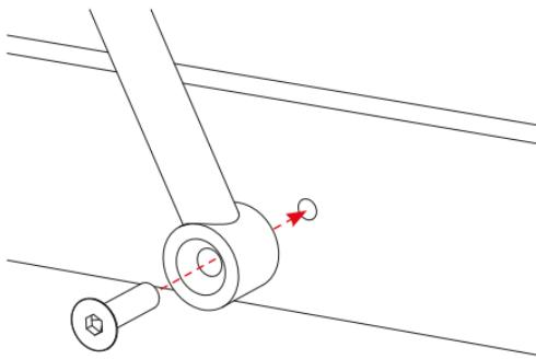
Ripetere l'operazione per la seconda e la terza gamba a V fig 5 e 7, controllare che la posizione dei montanti della gamba a V siano nella posizione indicata in fig. 6 e 8 inserire le 2 viti in dotazione avvitarle a fine corsa senza stringerle
