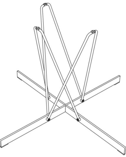
Prendere la quarta gamba a V posizionare il montante destro all'interno della gamba già montata ed il montante sinistro all'esterno della gamba montata, fig 9 inserire le 2 viti in dotazione avvitarle a fine corsa senza stringerle.
